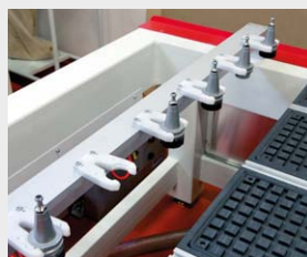
► Lineární zásobník na 6 nástrojů,
