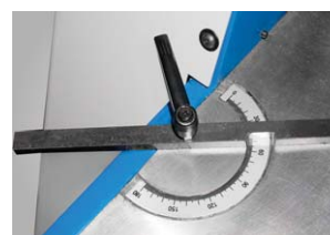
Nastavitelný úhlový doraz s milimetrovou stupnicí
