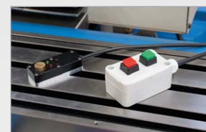
Senzor pro měření délky nástroje / tlačítko START/STOP
