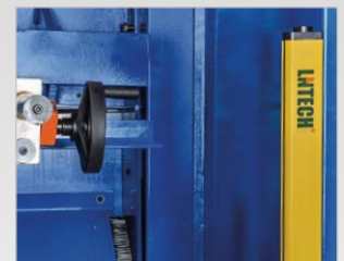
Optická čidla zabezpečují zadní prostor stroje.
