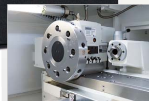
▶ Hydraulický výměník nástrojů VDI30 pro osm nástrojů
