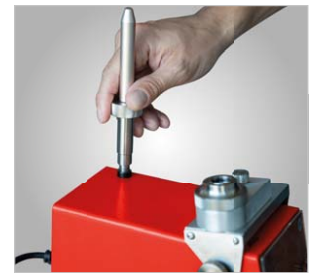
▶ Doraz pro nastavení správné délky broušení
