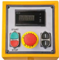
Ovládací pult s digitálním odměřováním
