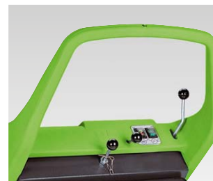
Ovládací prvky: Zapínání odsávání, mechanický oklep filtru, zvedání/spouštění bočního kartáče
