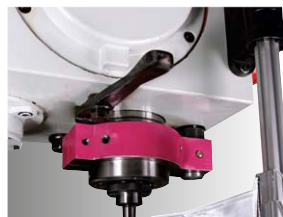
Vyražeč usnadňuje výměnu nástrojů
