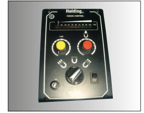
► Automatické zařízení pro odmagnetizování obrobku
