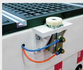
► Pneumatické dorazy materiálu
