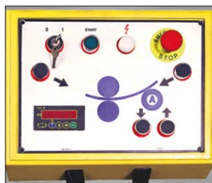
Digitální odměřování zadního válce (volitelné příslušenství)
