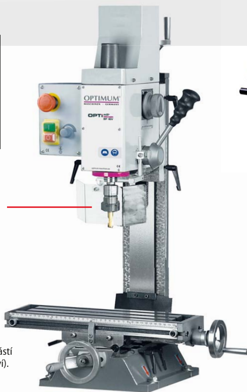
Sloup stranově přestavitelný o ±30 mm
