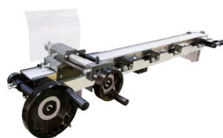
DB 1202 s ramenem pro soustružení velkých průměrů a odkládacím košíkem (volitelné příslušenství).
