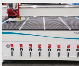
► Ovládání segmentů vakuového stolu
