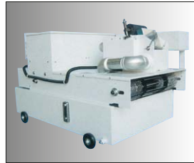
► Automatický papírový filtrační pás s magnetickým oddělovačem a chlazením
